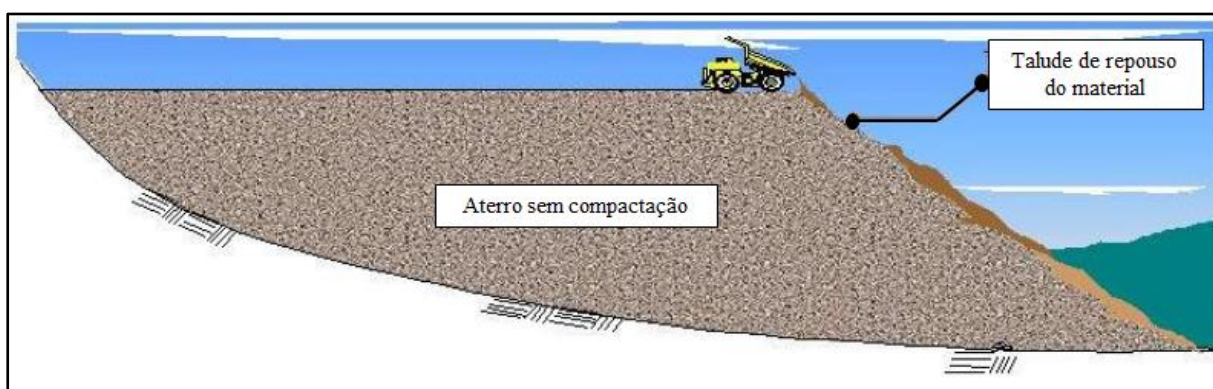
Figura 3.5 - Método construtivo descendente (modificado de Aragão 2008).
