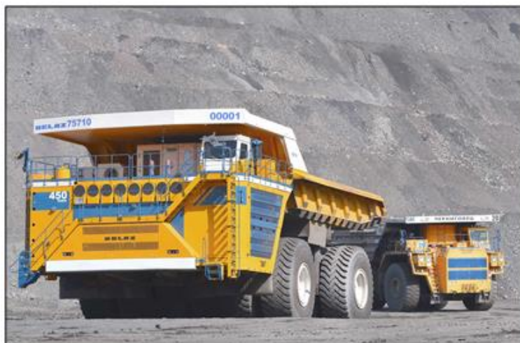
Figura 14: BELAZ 75710, caminhão com capacidade de 450 toneladas. Fonte: BELAZ (2021).
