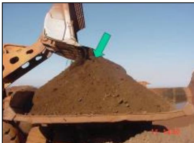
Figura 17: Centralização de carga na balsa dos caminhões. Fonte: COUTINHO (2017).
