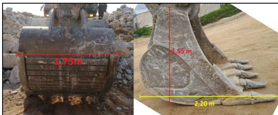
Figura 33: Dimensões da caçamba da retroescavadeira LIEBEHRR R 954 SME. Fonte: Autoria própria
