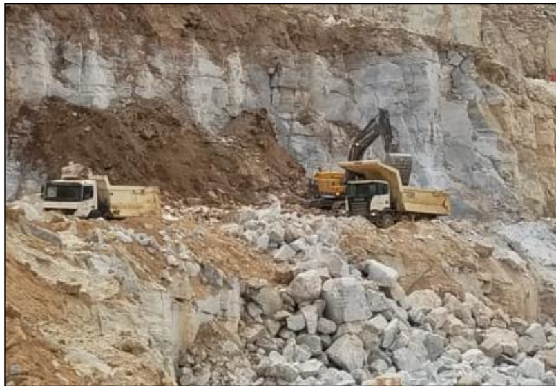
Figura 32: Carregamento transversal. Fonte: Autoria própria
