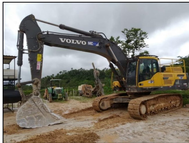
Figura 39: Retroscavadeira Volvo 380D locada, com caçamba de 3,0 m³. Fonte: Autoria própria.
