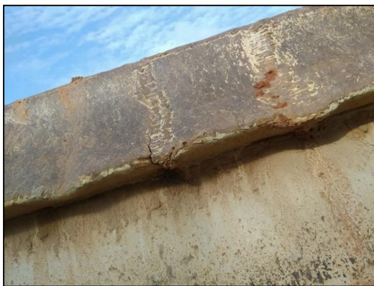
Figura 36: Trincas, soldas e avarias na caçamba do caminhão VW. 31-320. Fonte: Autoria própria.
