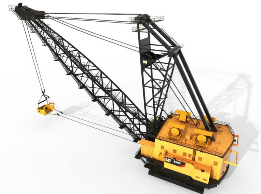
Figura 11: Escavadeira Drag-line CAT 8200 com acionamento a cabo. Fonte: RenderHub. (2021)
