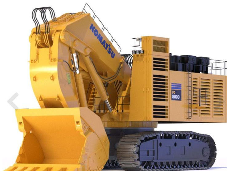
Figura 12: Escavadeira Shovel KOMATSU PC 8000 de acionamento hidráulico. Fonte: RenderHub (2021)
