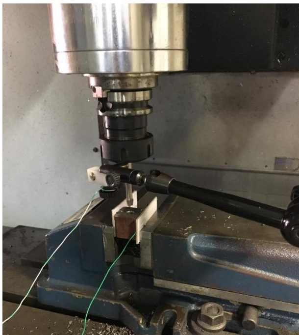
Figura 24 - Sistema de Aquisição de Temperatura Fonte: Pesquisa Direta (2021)
