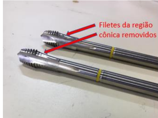
Figura 22 - Macho de Corte Depois da Alteração Fonte: Pesquisa Direta (2021)
