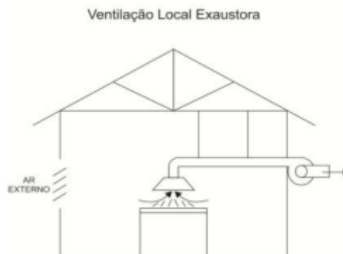
Figura 4 - Sistema de ventilação local exaustora. Fonte: Macintyre (1990)
