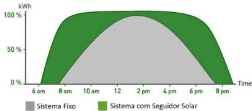
Figura 6: Comparação entre sistemas estacionários e rastreadores Fonte: VALLDOREIX GREENPOWER (2012)
