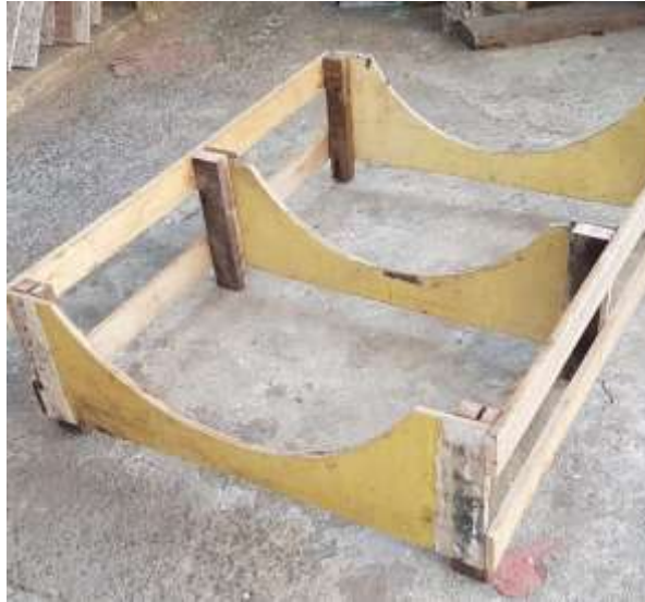
Figura 24: Construção do molde (base) Fonte: Pesquisa direta (2021)
