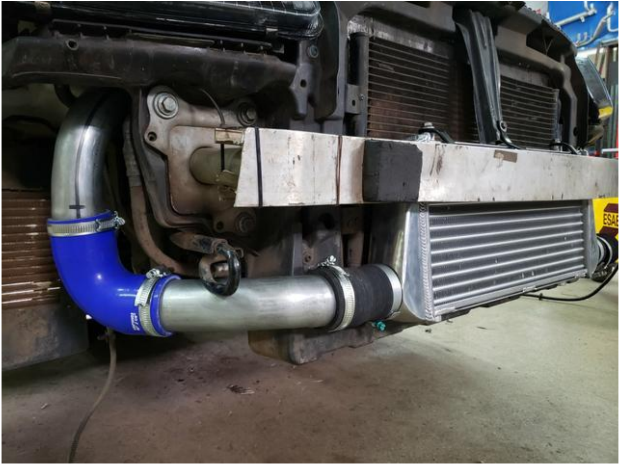
Figura 25 - Intercooler instalado na grade frontal de um carro Fonte: OLX (2021)
