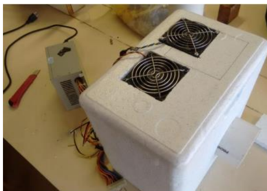
Figura 17: Protótipo do sistema de resfriamento evaporativo Fonte: Rafael (2019)
