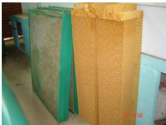
Figura 21: Painéis de argila expandida e painéis de celulose Fonte: Rosa (2009)
