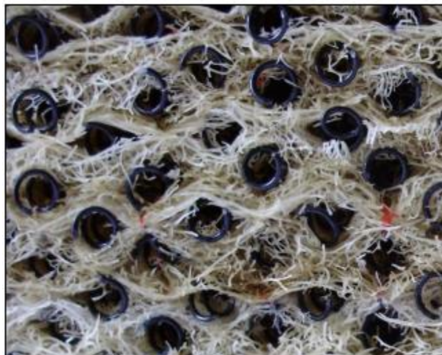
Figura 23: Painel com manta de fibra de Esponja Vegetal Fonte: Oliveira (2011)
