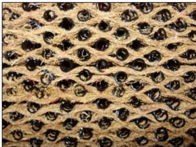
Figura 22: Painel com manta de fibra de coco Fonte: Oliveira (2011)
