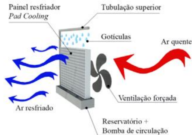
Figura 13: Princípio de funcionamento do RED Fonte: Maurya, et al apud Masiero et al. (2020)
