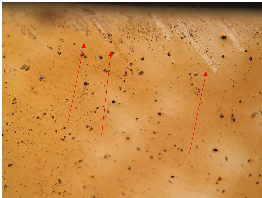
Figura 22 - Microestrutura do aço Hadfield após o ensaio D e com aumento de 200x. Fonte: Pesquisa direta (2021).
