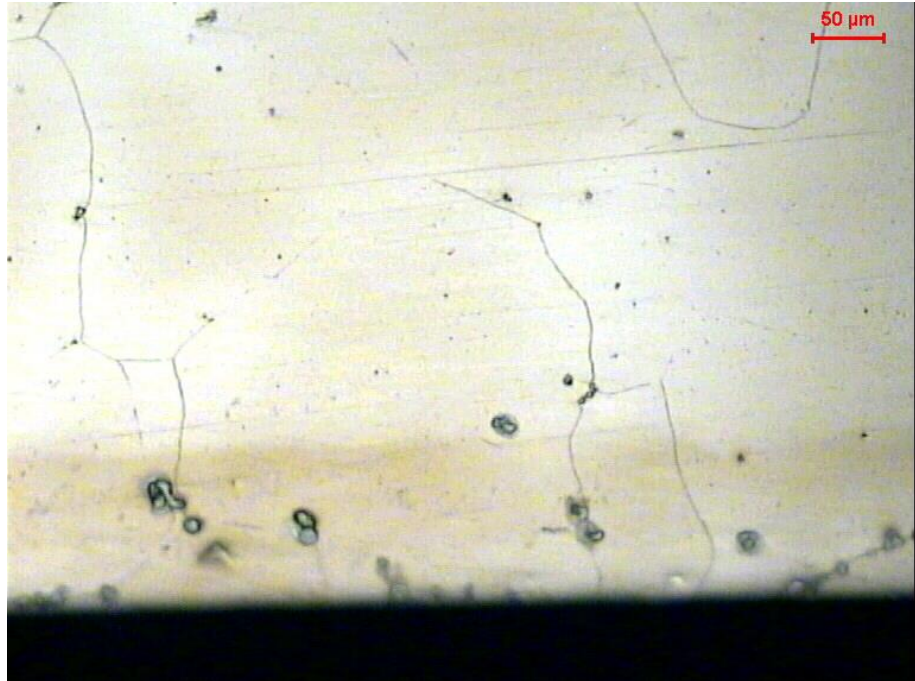
Figura 20 - Microestrutura do aço Hadfield após o ensaio C e com aumento de 200x. Fonte: Pesquisa direta (2021).
