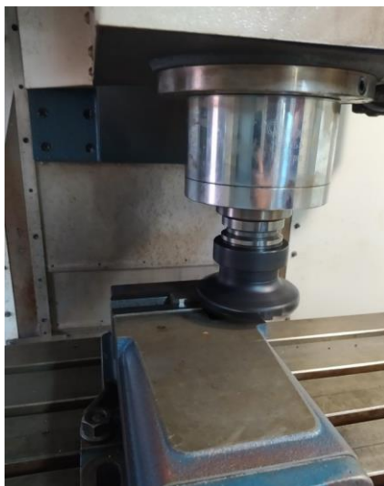
Figura 16 - Processo de fresamento dos corpos de prova. Fonte: Pesquisa direta (2021).
