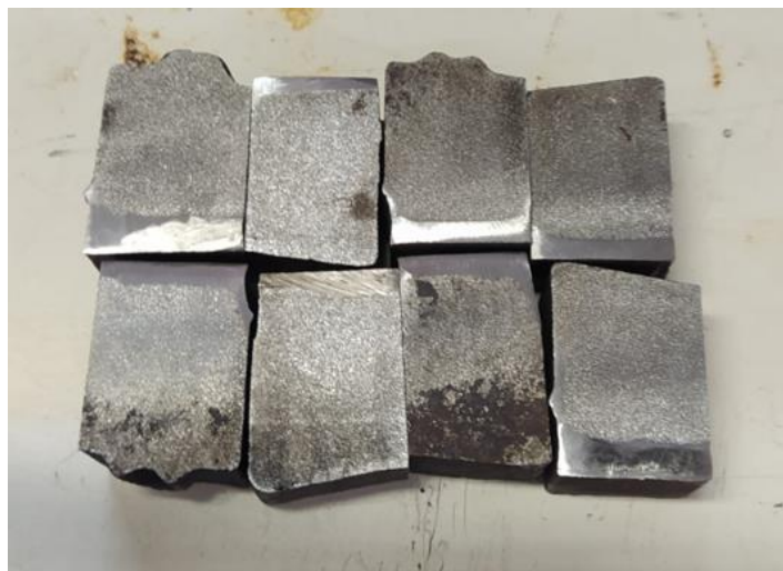
Figura 15 - Corpos de prova do aço Hadfield. Fonte: Pesquisa direta (2021).
