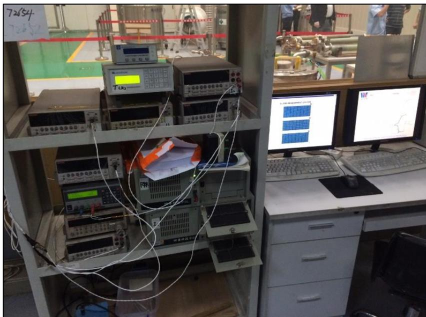
**Figura 12 : Fotografia das instalações de medida RRR da empresa WST (China) [16]**
