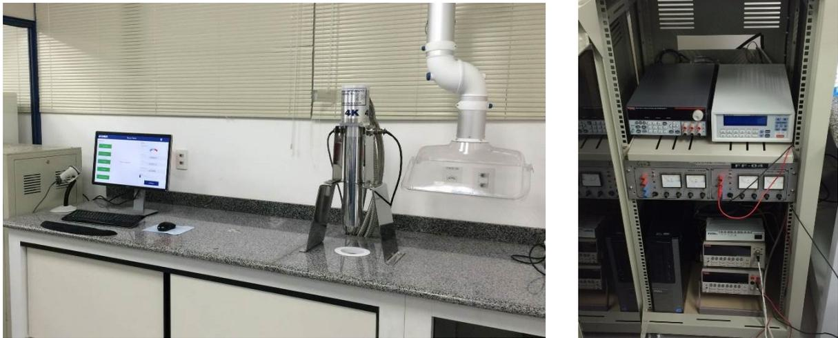
**Figura 24:** A esquerda unidade de medida instalada com cryocooler e sistema de interface com o operador. A direita instrumentos da unidade de medida. [Autorial, 2021]
