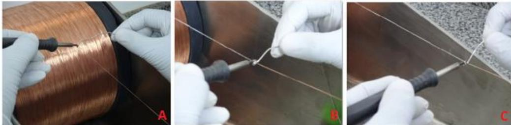
**Figura 29. Recobrimento do fio de cobre com uma liga a base de estanho. [Autorial, 2021]**
