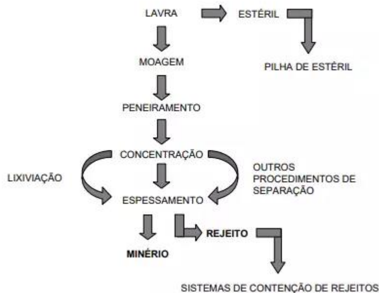
Figura 1 — Esquema geral do processo de formação de rejeitos
