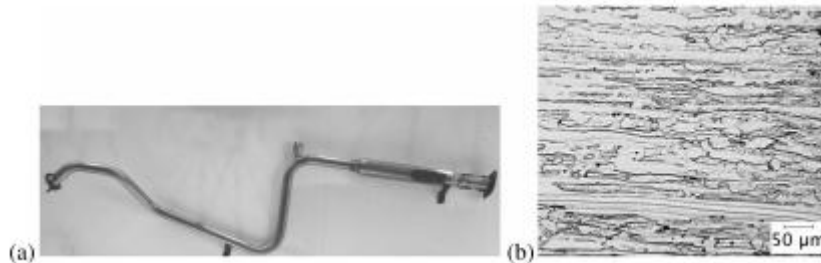
Figura 4. 1- (a) Um tubo do sistema de exaustão para um automóvel, feito com aço inoxidável ferrítico 409L. (b) A microestrutura ferrítica na condição laminada a quente (AHN et al, 2012).
