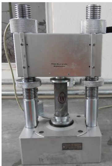
Figura 3.10 – Equipamento utilizado para realização de ensaios de UCS e PLT. Na imagem, corpo de prova de UCS
