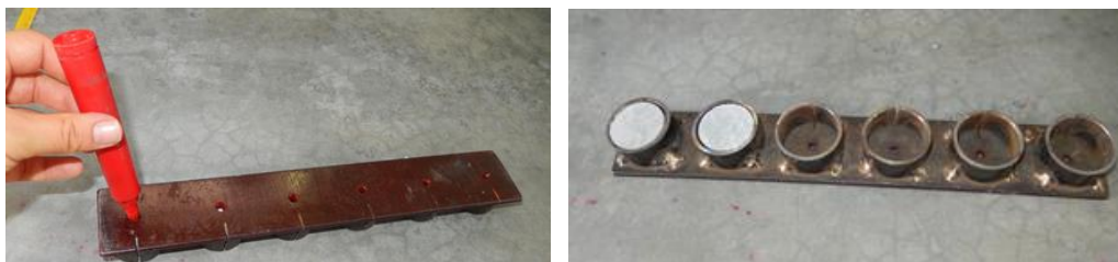
Figura 3.9 – Marcação do centro das amostras de PLT para melhor centralização das mesmas na realização do ensaio
