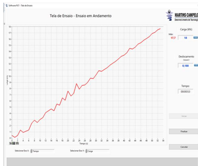
Figura 3.11 – Exemplo de representação dos resultados de ensaio em andamento no software PLT Automático (2019). Representação da curva tempo x carga antes da ruptura
