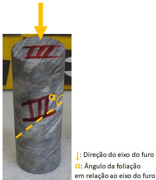
Figura 3.5 – Ilustração do corpo de prova com a direção do eixo do furo em relação ao ângulo da foliação
