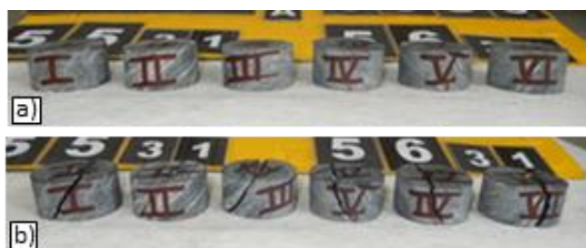
Figura 3.8 – Fotografia dos corpos de prova a) antes e b) após a ruptura. Exemplos para amostras PLT
