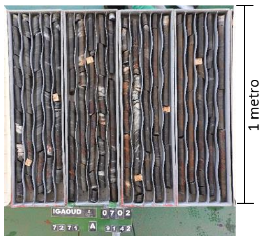
Figura 3.1 – Quatro caixas totalizando 20 metros de testemunhos de sondagem utilizados para descrição geotécnica, onde é retirado um metro (lote) para realizar os ensaios.
