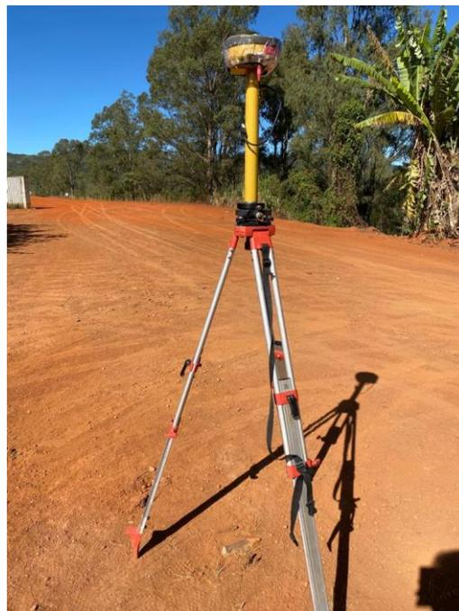
**Figura 14: Imagem ilustrativa do equipamento GNSS RTK.**
