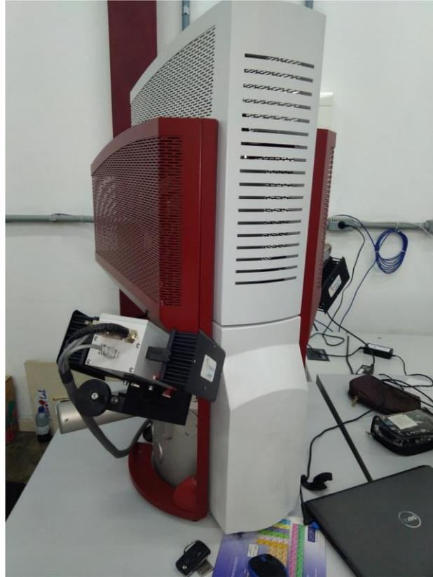
Figura 4.1 - Microscópio Eletrônico de Varredura (MEV) que possui o sistema TIMA no NanoLab da REDEMAT/DEMET-EM-UFOP.
