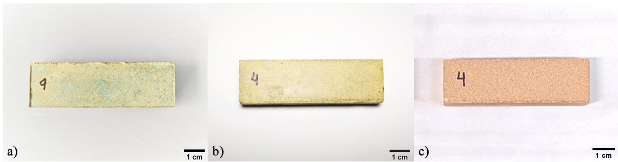
Figura 5.4 – Corpos de prova após as etapas de a) conformação, b) secagem e c) queima
