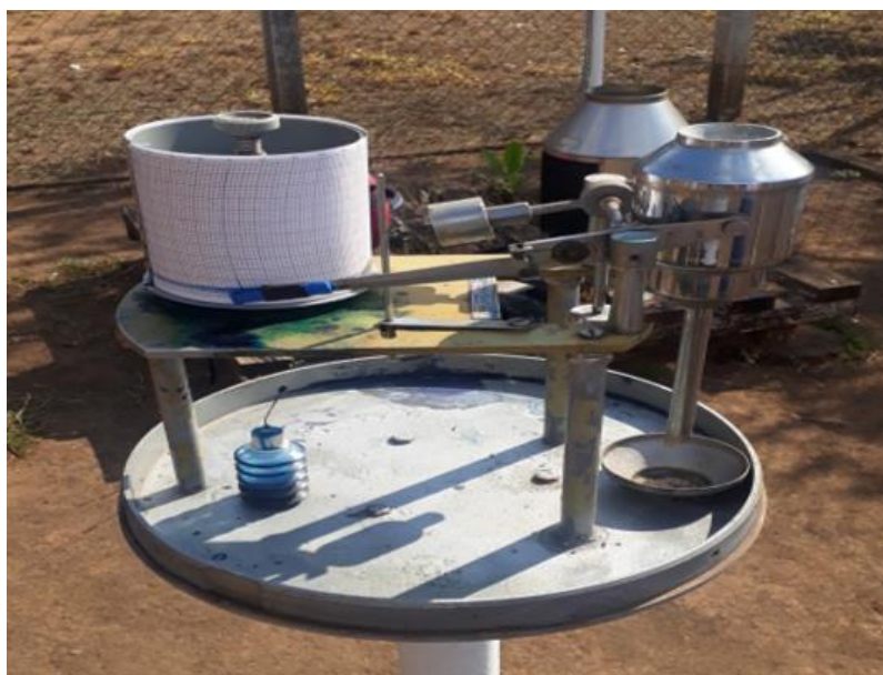
Figura 2 – Pluviógrafo de caçamba basculante localizado na estação de coleta de dados meteorológicos 1943022.
