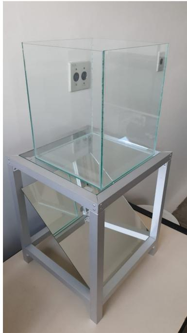
Figura 3.2: Demonstração da montagem do *splash test*.
