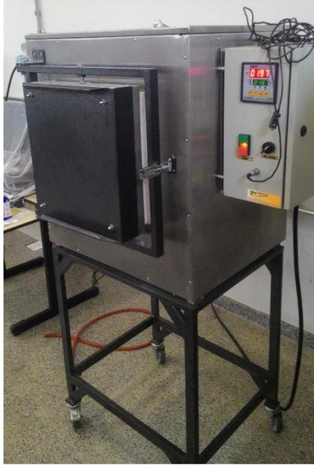
Figura 10 – Forno mufla Fortlab.
