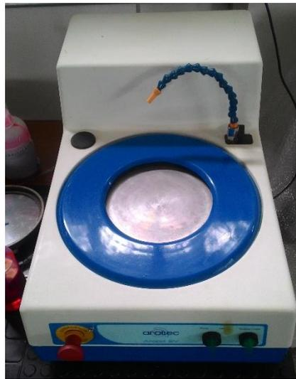
Figura 13 – Lixadeira/politriz metalográfica da marca Arotec, modelo Aropol 2V.
