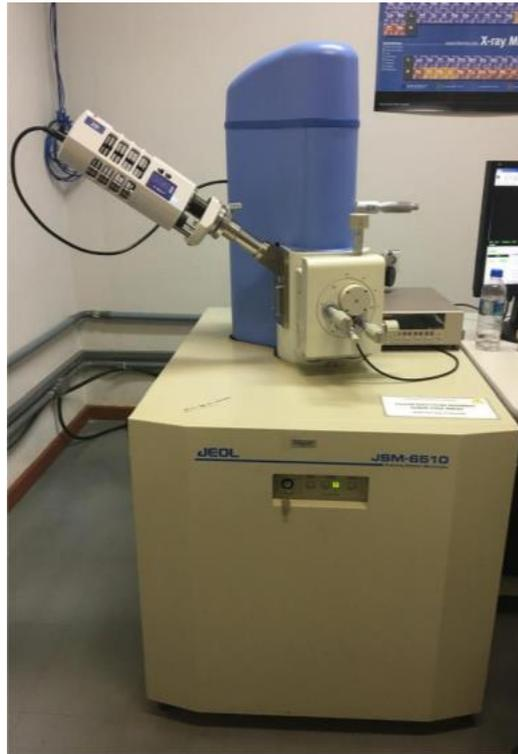
Figura 15 - Microscópio eletrônico de varredura Jeol JMS 6510.
