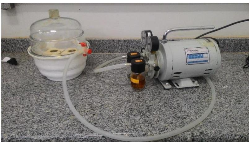
Figura 12 - Montagem do dessecador e bomba de vácuo.
