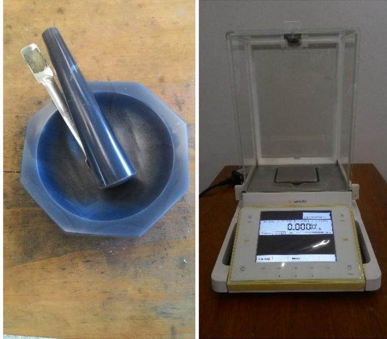
Figura 7 - Gral de ágata com pistilo, à esquerda, e balança Sartorius à direita.
