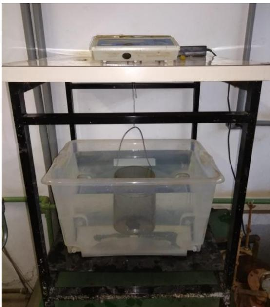
**Figura 23 – Sistema de pesagem hidrostática (arquivo pessoal).**
