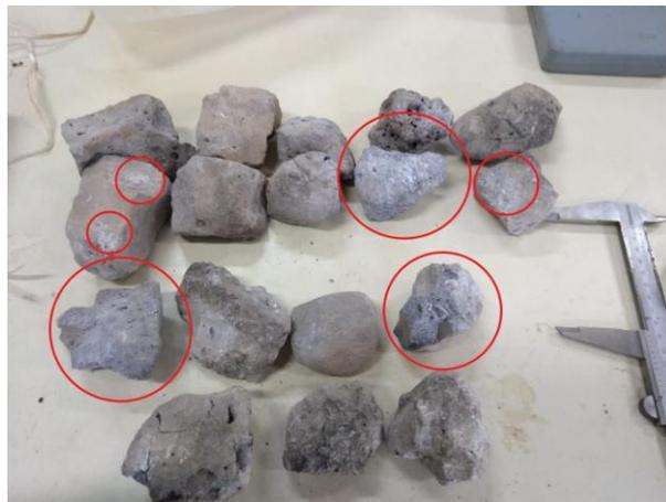
**Figura 118 – Eflorescências observadas em alguns corpos de prova retidos na peneira de 38mm do ensaio de determinação da forma dos fragmentos da amostra de escória de aciaria submetida a 40 ciclos de imersão em solução de sulfato de sódio (arquivo pessoal).**
