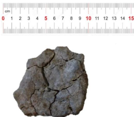
**Figura 110 – Abertura de trincas em um fragmento de escória de aciaria LD da amostra submetida a 40 ciclos de imersão em solução de sulfato de sódio. A fotografia foi tirada com 40 ciclos (arquivo pessoal).**
