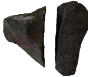
**Figura 111 – Quebra do corpo de prova BA-RI-40-CP6. A fotografia foi tirada com 5 ciclos (arquivo pessoal).**
