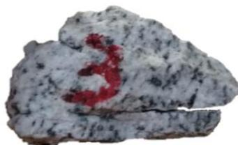
**Figura 114 – Abertura de trinca no corpo de prova GN-RI-40-CP3. A fotografia foi tirada com 40 ciclos (arquivo pessoal).**
