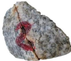
**Figura 112 – Quebra do corpo de prova GN-RI-40-CP2. A fotografia foi tirada com 20 ciclos (arquivo pessoal).**
