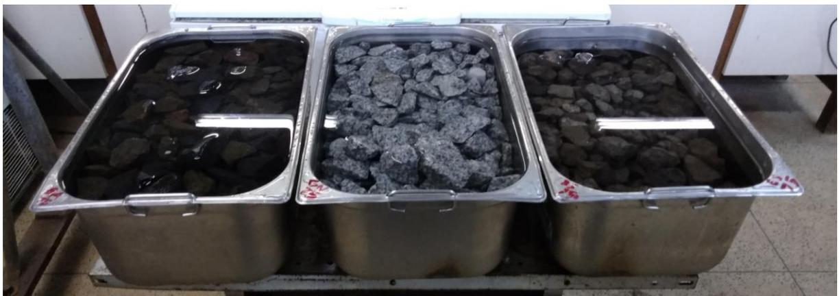
**Figura 43 – Descongelamento e manutenção da saturação dos materiais (arquivo pessoal)**
