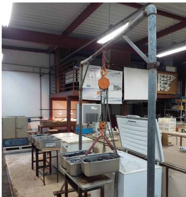
**Figura 41 – Sistema utilizado para o congelamento dos materiais (arquivo pessoal).**
