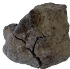
**Figura 67 – Fissuração em um fragmento de escória de aciaria LD. A fotografia foi tirada com 22 ciclos de congelamento e degelo (arquivo pessoal).**
