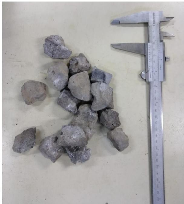
**Figura 22 – Determinação da forma dos fragmentos pelo método do paquímetro (arquivo pessoal).**
