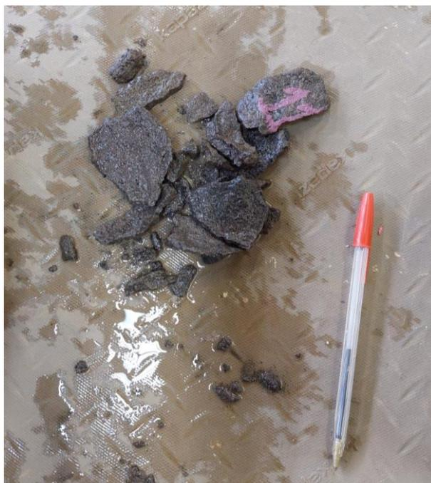
**Figura 116 – Quebra do corpo de prova BA-20-IQ-ME-CP11 (corpo de prova reserva) antes da pesagem na condição SSS (arquivo pessoal).**
