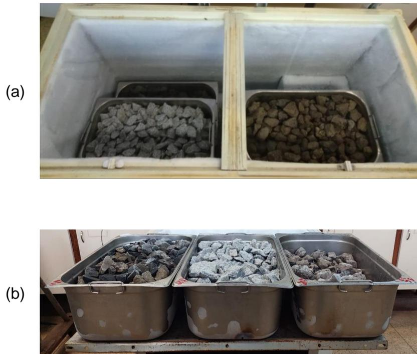
**Figura 42 – Congelamento dos materiais. (a) dentro do freezer. (b) Após extraído (arquivo pessoal).**
