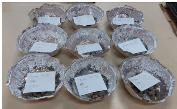
**Figura 29 – Corpos de prova do ensaio de determinação da resistência ao choque (arquivo pessoal).**
