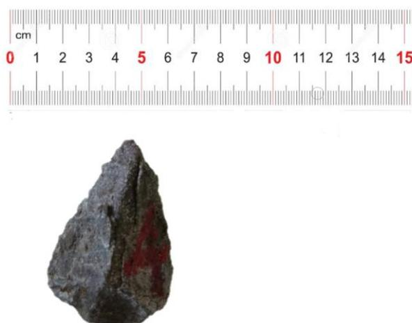
**Figura 107 – Desagregação das camadas do corpo de prova BA-RI-40-CP4. A fotografia foi tirada com 20 ciclos (arquivo pessoal).**
