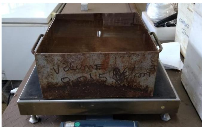
**Figura 26 – Calibração da caixa para o ensaio de massa unitária (arquivo pessoal).**
