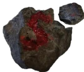
**Figura 113 – Quebra do corpo de prova BA-RI-40-CP6. A fotografia foi tirada com 36 ciclos (arquivo pessoal).**
