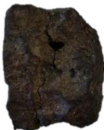
**Figura 109 – Fissuração do corpo de prova ES-RI-40-CP2. A fotografia foi tirada com 36 ciclos (arquivo pessoal).**
