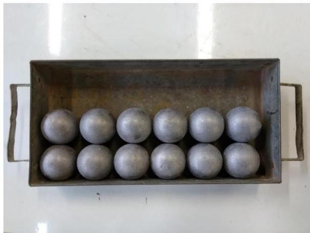
**Figura 33 – Carga abrasiva utilizada no ensaio de determinação da resistência à abrasão (arquivo pessoal).**
