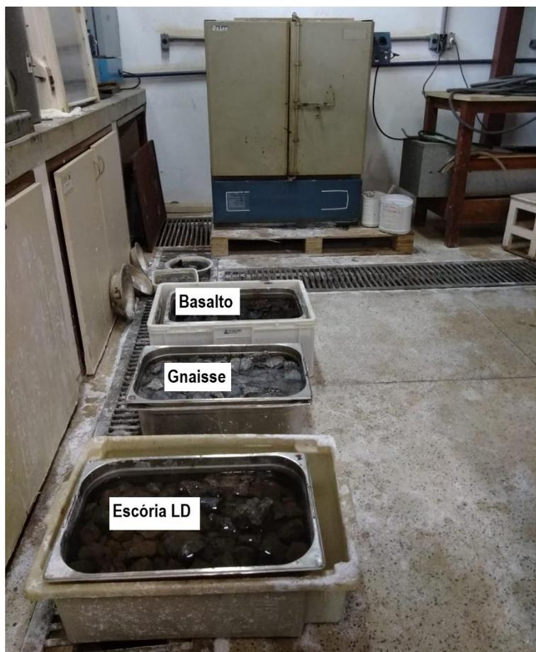
**Figura 45 – Materiais imersos na solução de sulfato de sódio (arquivo pessoal).**
