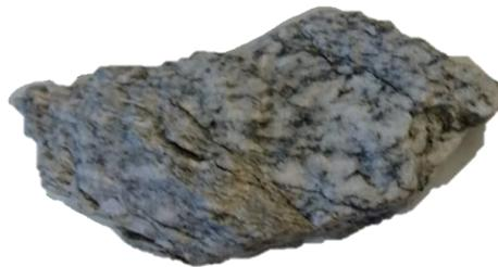
**Figura 108 – Desagregação das camadas do corpo de prova GN-RI-40-CP5. A fotografia foi tirada com 33 ciclos (arquivo pessoal).**
