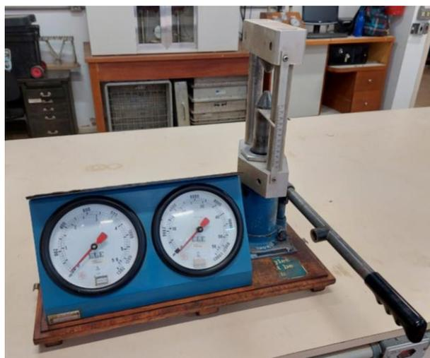
**Figura 37 – Equipamento de aplicação de carga pontual (arquivo pessoal).**
