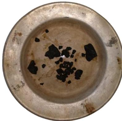
**Figura 66 – Fragmentação de uma partícula de basalto da amostra submetida a 25 ciclos de congelamento e degelo. A fotografia foi tirada com 13 ciclos (arquivo pessoal).**
