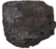
**Figura 117 – Eflorescência de sulfato de sódio no corpo de prova BA-RI-40-CP5. A fotografia foi tirada com 40 ciclos (arquivo pessoal).**
