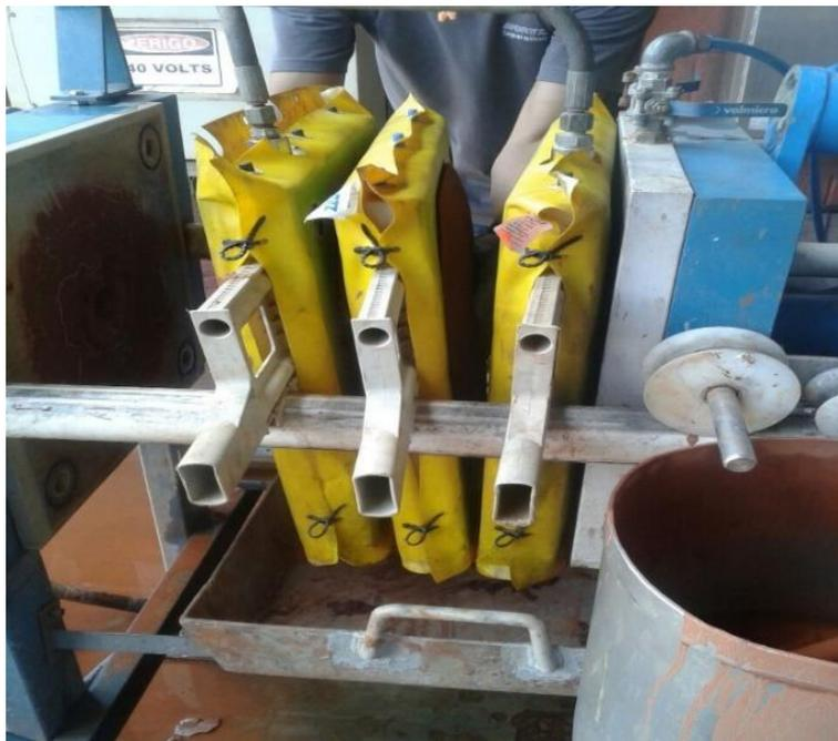
Figura 31: Câmaras de filtragem pertencente ao filtro prensa piloto.
