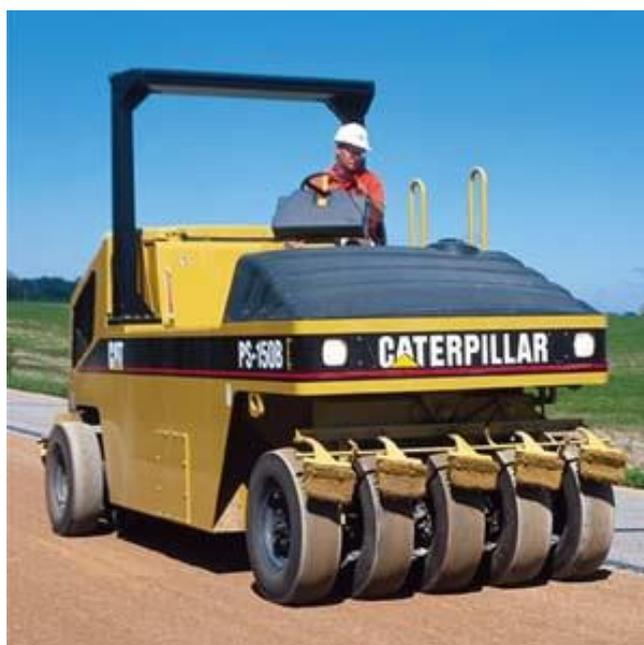
Figura 23: Rolo compactador pneumático.
