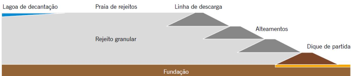
Figura 1: Modelo clássico do método de alteamento a montante. Inicia-se a construção por um dique de partida e a barragem passa por sucessivos alteamentos ao longo de sua vida útil no sentido de montante, sobre o rejeito anteriormente depositado.
