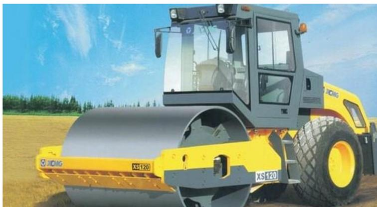
Figura 22: Rolo compactador liso vibratório.
