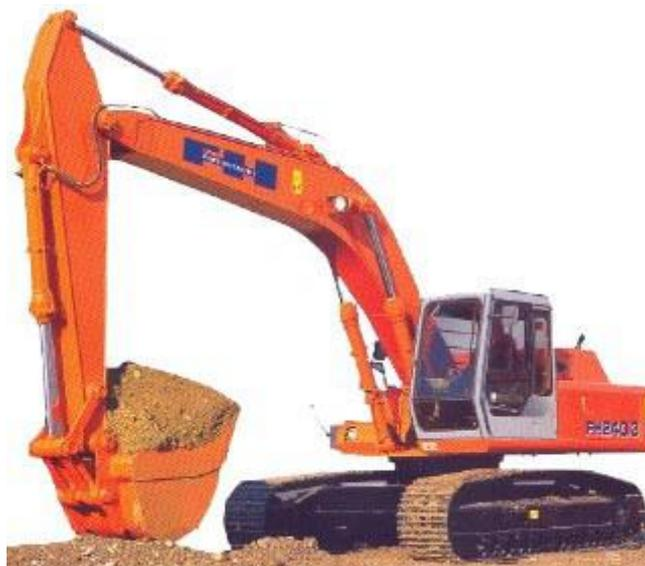
Figura 16: Escavadeira hidráulica de esteira equipada com concha.
