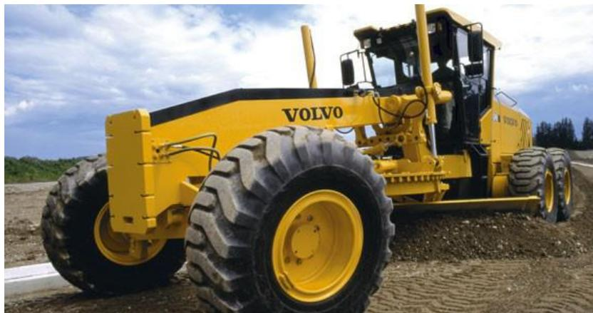
Figura 17: Motoniveladora realizando espalhamento do solo. É possível perceber, em sua região inferior-central, a lâmina realizando o trabalho.
