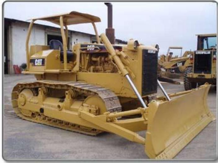
Figura 14: Trator de esteiras equipado com lâmina.
