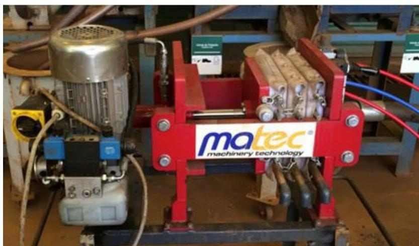
Figura 29: Filtro prensa piloto utilizado no processo de filtragem da amostra de rejeito de minério de ferro em forma de polpa, com 60% de sólidos (W/W).
