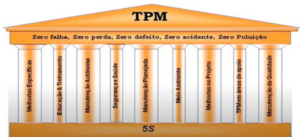
Figura 2- Base e pilares do TPM. Fonte: Ribeiro (2014, p. 26).
