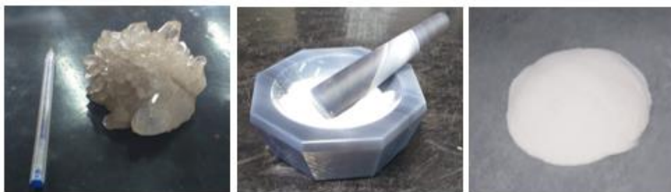
Figura 9 - Sequência de preparação da amostra de quartzo utilizada nos experimentos de microflotação
