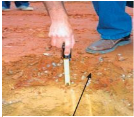
(b) Solo-brita descontínuo: detalhe da camada compactada
