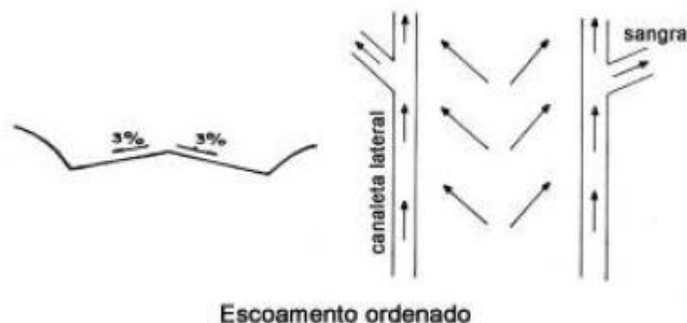
Figura 6 - Importância da drenagem superficial de vias de acesso
