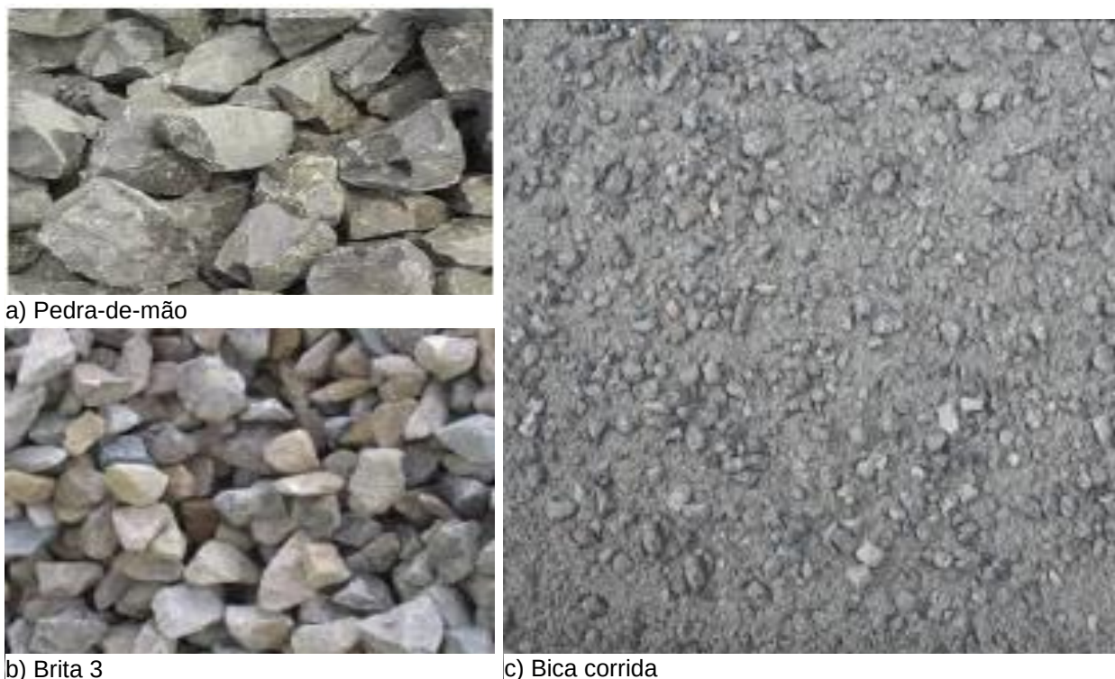
Figura 32 – Materiais das camadas de base e revestimento
