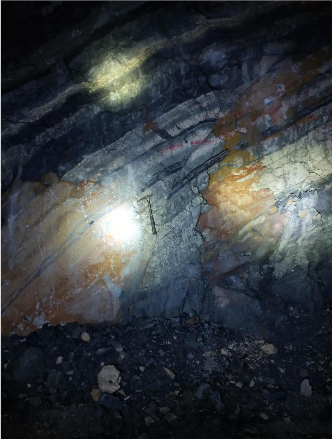
*Figura 3 - Falha mapeada na mina. Destaque para o plano de quebra rúptil característico a esse tipo de estrutura*
