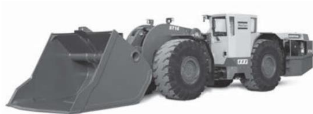
Figura 6 – LHD movida à diesel
