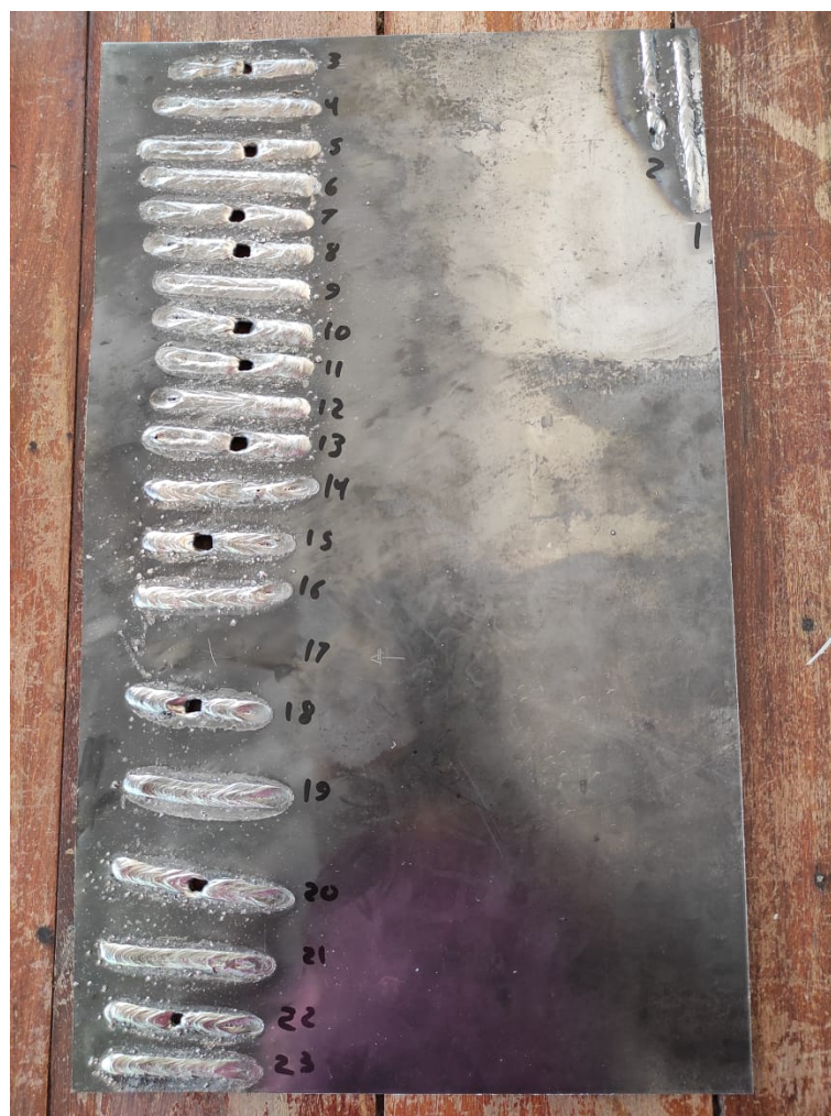
Figura 18 – Chapa com os cordões dos ensaios 1 a 23.
