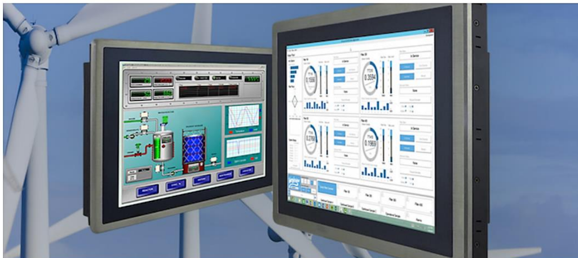
Figura 1 - Interface Homem-Máquina antes e depois de aplicação da norma IEC 63303 Fonte: Brasil Logic Sistemas – Regulamentando a Interface Homem-Máquina: Conheça a ISA101
