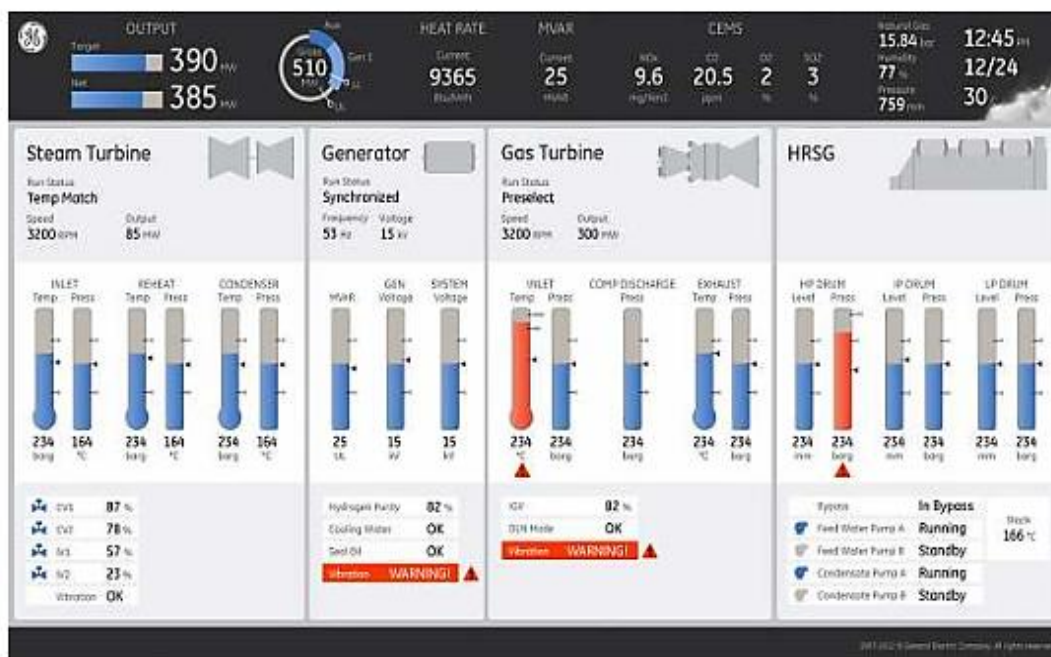
Figura 30 - Tela de operação IHM alta performance Fonte: GE e Aviva (2018)
