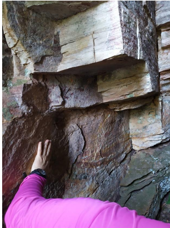
Figura 4.11 - Fraturas com padrão quadrangular provocado pela interseção de planos de fratura de menor persistência. Fonte: acervo pessoal.
