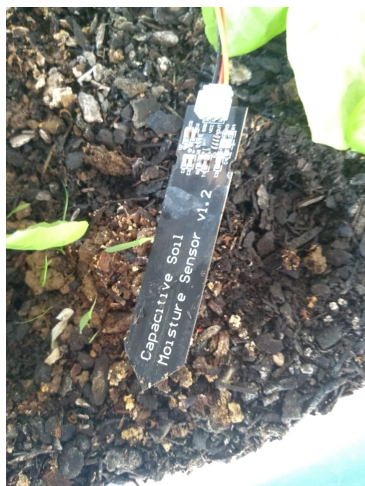
Figura 13 – Sensor de umidade CS12.
