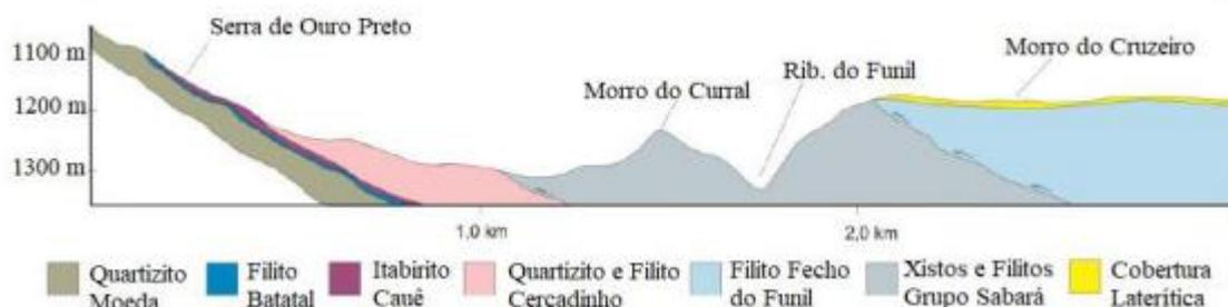
Figura 4 – Seção geológica esquemática com a disposição geral das principais unidades litológicas. Modificado de CPRM, 2016. Fonte: Ferreira (2018).
