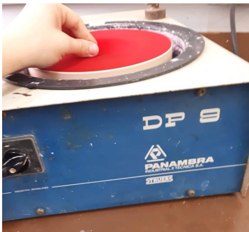
Figura 1.3- Processo de polimento realizado nas pastilhas. Politriz de modelo DP9 da marca Panambra.
