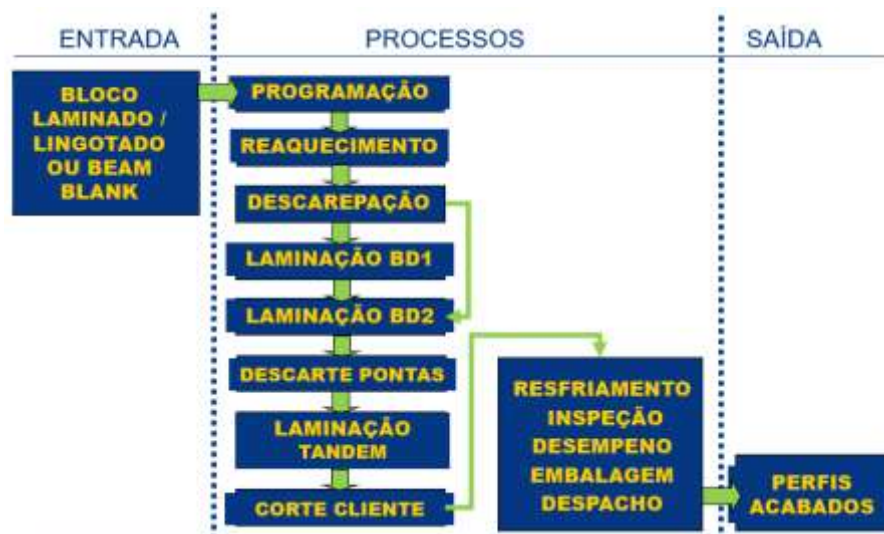
Figura 2 – Etapas do processo de laminação de perfis Fonte: ABM (2003).
