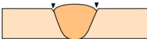
Figura 17: Esquema da descontinuidade mordedura no processo de soldagem.
