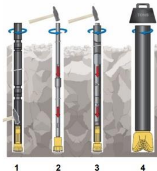
Figura 3 – Métodos de perfuração – 1 Martelo de Fundo, 2 e 3 Martelo de cabeça, 4 Rotativa
