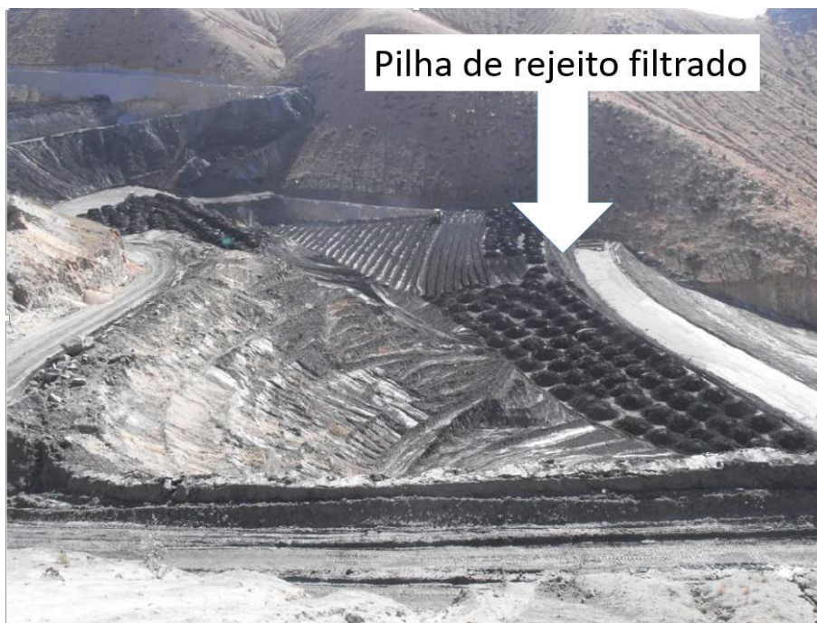
Figura 20 - Pilha de Rejeito Filtrado em Operação da Mina de Cerro Lindo (Peru)
