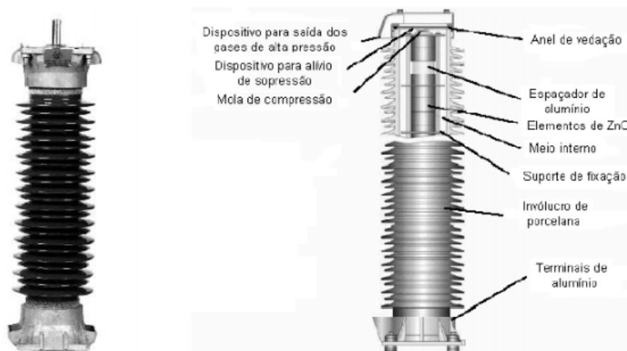
Figura 20 – Para-raio de silício (SiC)
