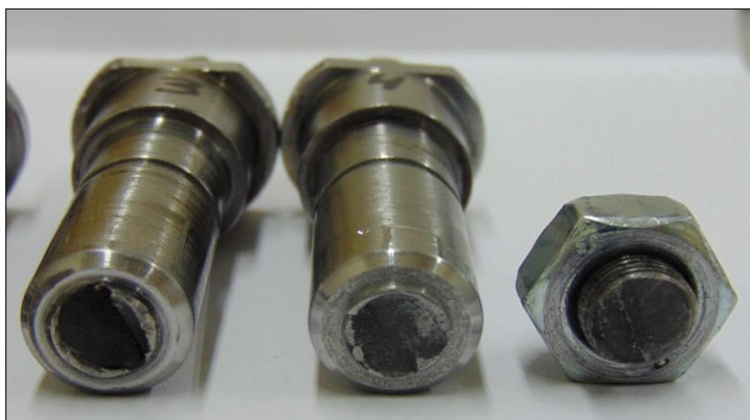
Figura 18: Aspecto macrográfico da face de fratura dos dois eixos do fabricante Líder. A porca com a parte rosqueada do eixo pertence ao eixo 4 – Aumento: 2x
