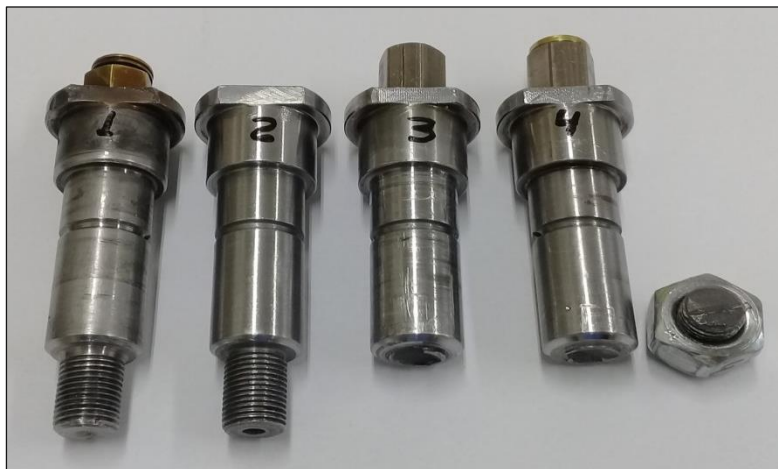
Figura 17: Aspecto macrográfico das amostras de eixo recebidas para análise, sendo duas com fratura na haste rosqueada - Aumento: 1x
