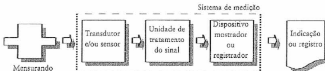
Figura 7 – Componentes de um sistema de medição.
