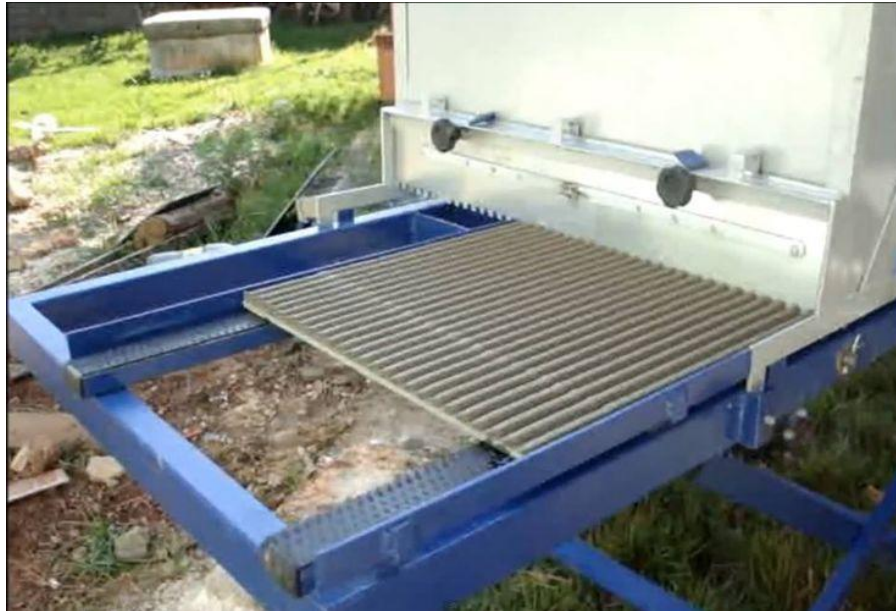
Figura 5.7: “Máquina aplicadora de argamassa”
