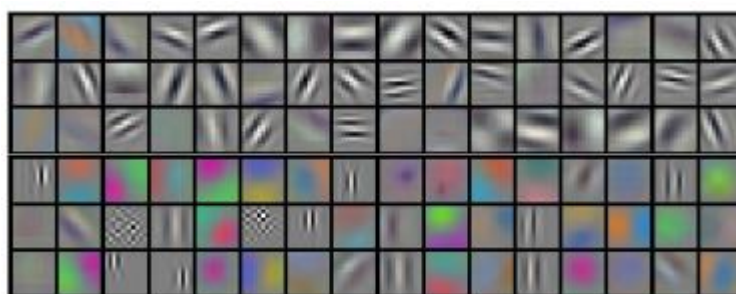
Figura 14 – 96 filtros tamanho 11x11x3 da primeira camada de convolução de uma rede de convolução.
