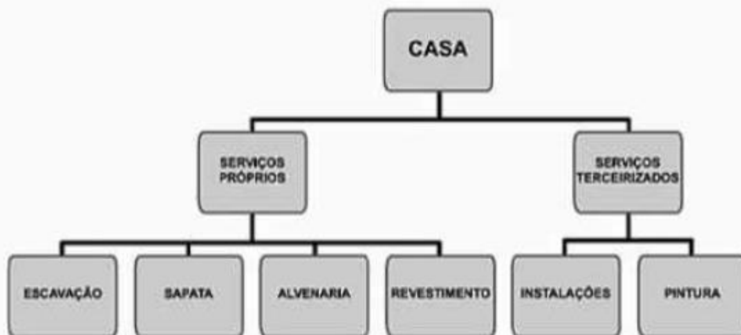
Figuras 4 (a,b,c,d,e): Diferentes maneiras de realizar um EAP (partes físicas, por grandes serviços, por especialidades de trabalho, por etapas globais, por tipo de contratação) Fonte: Aldo Mattos- Planejamento e Controle de Obra (2010).
