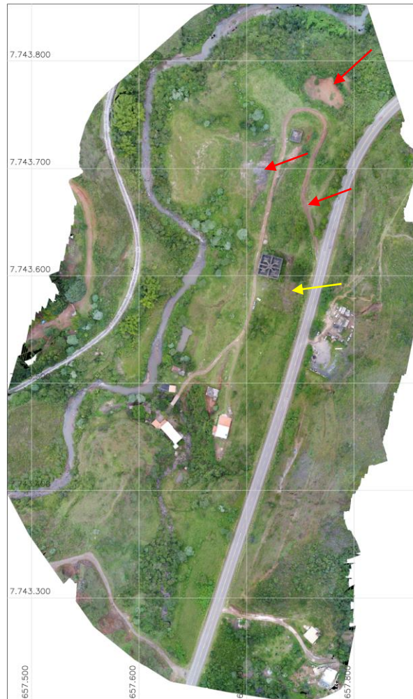
Figura 5.19 - Imagem do VANT gerada em 2018 com as setas indicando cicatrizes de escorregamentos que ocorreram na área.
