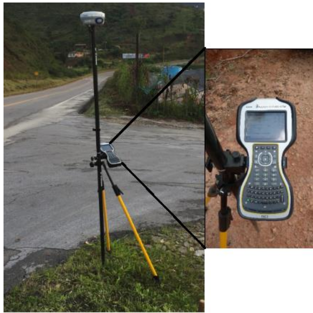
Figura 5.2 - Equipamento utilizado para a realização do geoposicionamento com RTK.
