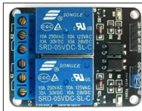
Figura 14: Módulo com dois relés (10A - 110V/220V)
