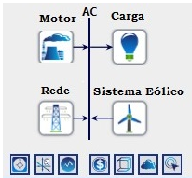
Figura 21 – Topologia do sistema Eólico-Gerador
