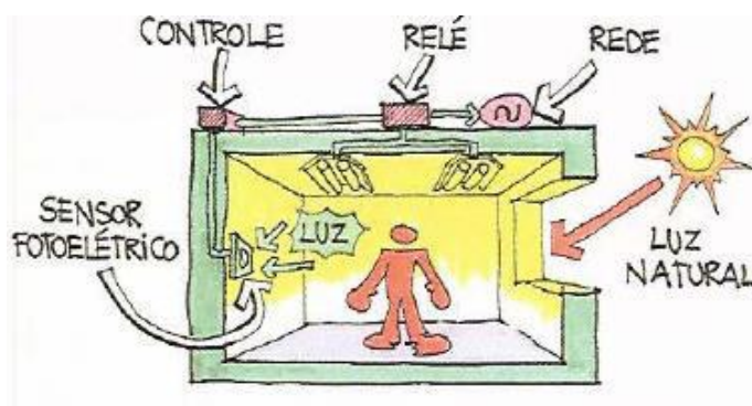
Figura 2.6 – Sistema de iluminação por controle fotoelétrico
