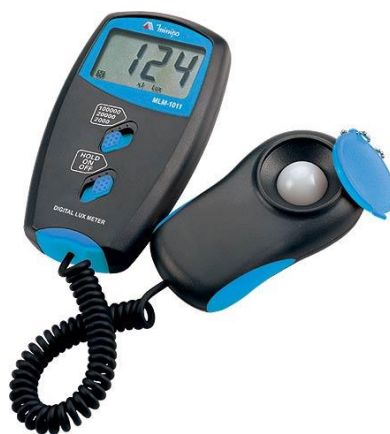
Figura 1 - Luxímetro digital YK-10 LX (Fonte: Impac Comercial e Tecnologia Ltda.)
