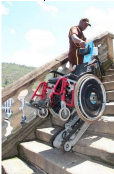
Figura 10: Mecanismo de transporte inclinado de uma cadeira de rodas
