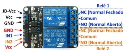
Figura 4.12– Ligações do shield relé
