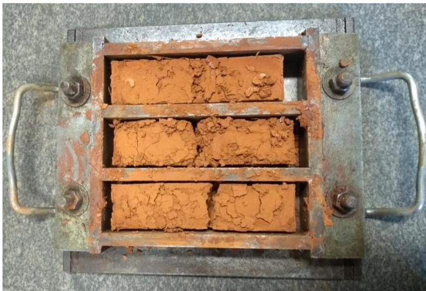
Figura 22 – Corpos de prova de LV pura. Fonte própria.
