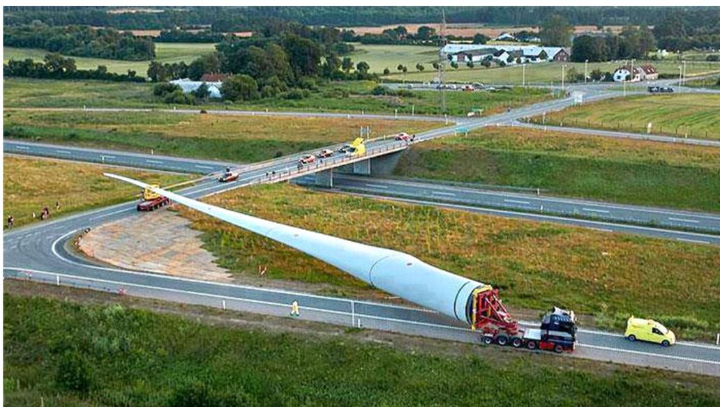
Figura 4 – Transporte de Pá Eólica em 2014 na Alemanha. Fonte: (TECMUNDO, 2014)
