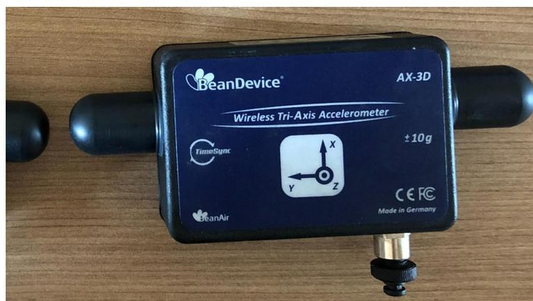
Figura 5 – Acelerômetro AX-3D da BeanAir. Fonte: Arquivo pessoal
