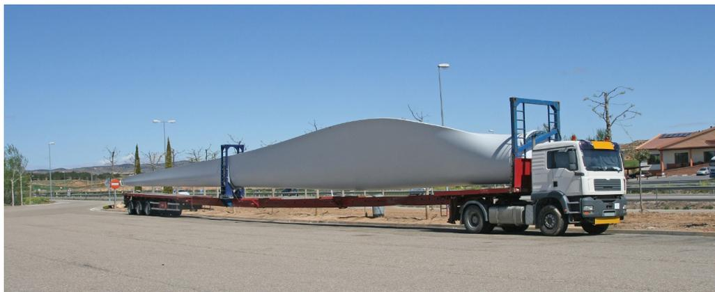
Figura 14 – Conjunto transportador semelhante ao utilizado no teste rodoviário. Fonte: Arquivo Pessoal.
